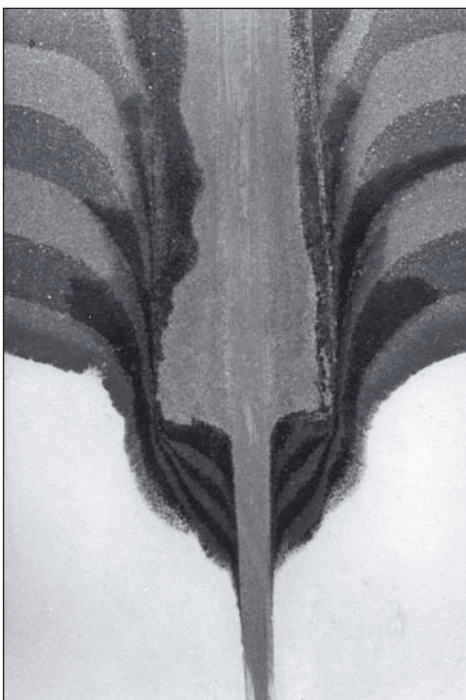
Bild 10: Verschleppter Bodenkörper unter der Dichtungspombe
