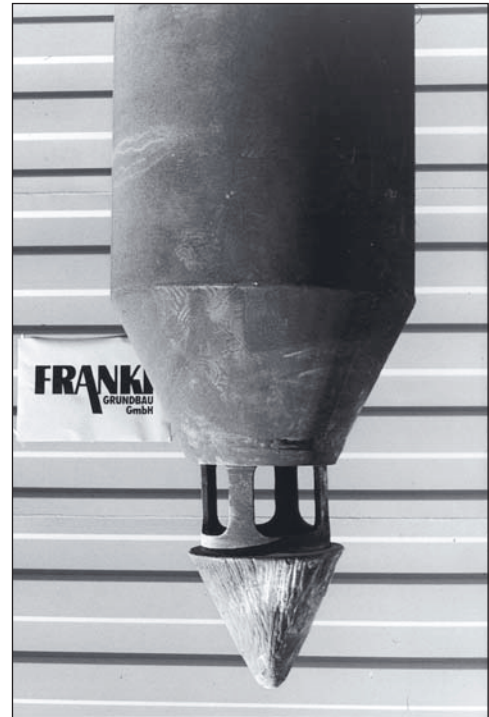
Bild 13: Vortreibrohr mit spezieller Spitzenausbildung zur Herstellung von Dichtungsploben
